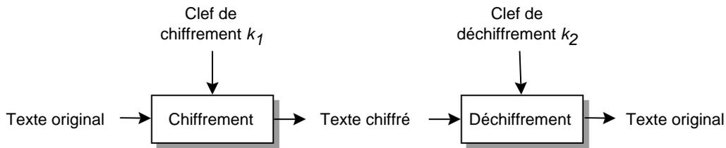
FIG. 3.10 – Chiffrement et déchiffrement avec deux clefs distinctes.
